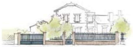
La clôture est composée d'un muret avec grille, où viennent s'intercaler portail et portillon.
