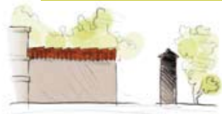
Un haut mur de moellons chaperonné crée une barrière visuelle, tandis qu'un muret surmonté d'une barrière à claire-voie laisse deviner le jardin.
