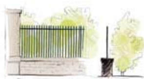
Murets et murs bahuts sont surmontés de grilles métalliques et encadrés de piliers maçonnés.
